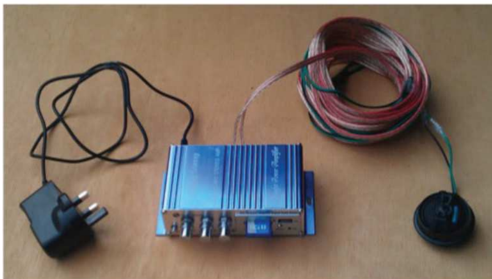
Fot. 122. Najprostszy zestaw do wabienia akustycznego jerzyków, składający się z odtwarzacza mp3 ze wzmacniaczem, zasilacza i głośnika samochodowego (DN)
